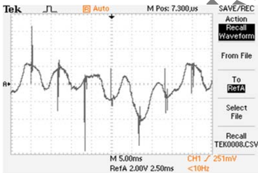
شکل ۱۲. ولتاژ شفت اندازه گیری شده در سمت متصل به سیستم تحریک در فرکانس های پایین
