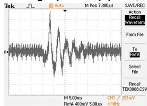
شکل ۱۵. ولتاژ شفت اندازه‌گیری شده در سمت متصل به توربین در فرکانس‌های بالا
