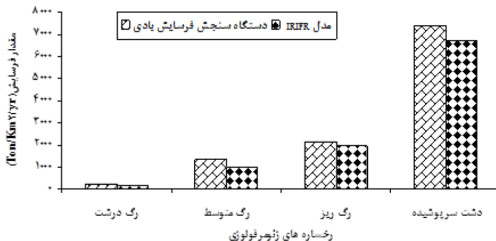
شکل ۵- مقایسه مقادیر فرسایش بادی رخساره‌های دشت سگزی بر اساس مدل IRIFR1 و دستگاه سنجش فرسایش بادی
