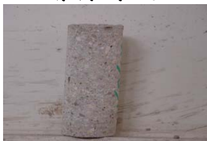
شکل ۵: نمونه مغزه با درجه ۱.
