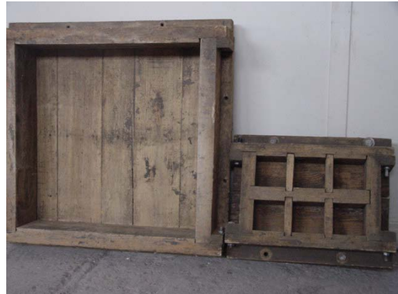
شکل ۲: نمونه های جعبه ای به منظور مغزه گیری از بتن پاشیده.
