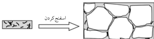
شکل ۵- طرح‌واره اثر اسفنج کردن بر آرایش نانولوله‌های کربن در ماتریس پلیمری.
