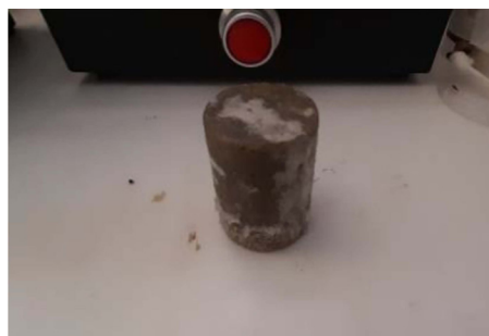
شکل ۲۳ نمونه مغزه پس از سیلاب زنی با فیلترات گل حفاری بهبود یافته
