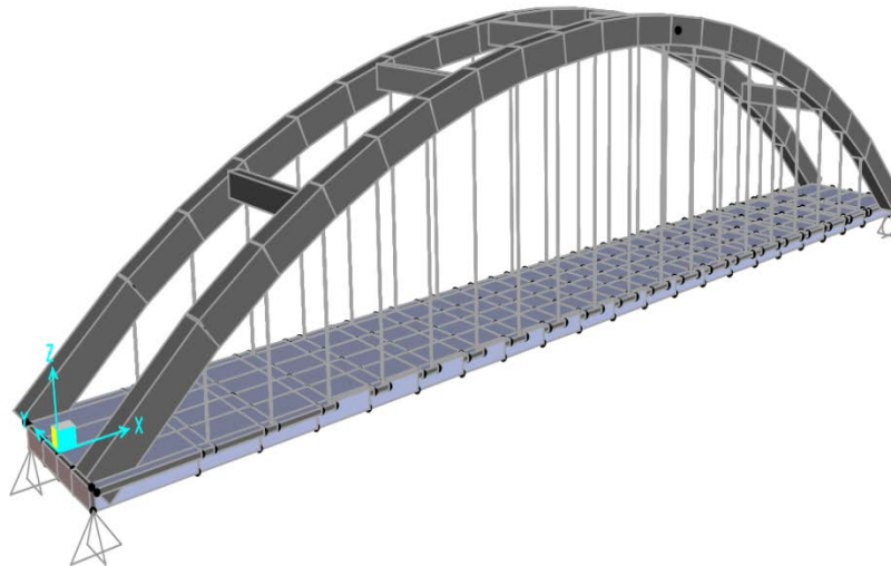
شکل ۲- مدل المان محدود قسمت قوسی پل آمل
