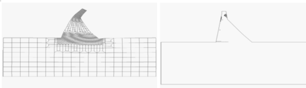
شکل ۶. انتشار ترک و تغییر شکل سد بلواستون تحت رکورد زلزله کرن کانتی با مدل پی بدون جرم ( E_f=20\text{GPa} )، درصد ناحیه ترک خورده = ۷٪
