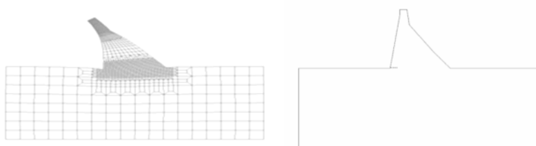
شکل ۵. انتشار ترک و تغییر شکل سد بلواستون تحت رکورد زلزله کرن کانتی با مدل پی بدون جرم ( E_f=40\text{GPa} )، درصد ناحیه ترک خورده = ۳٪
