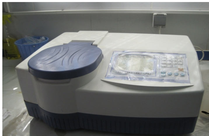
شکل ۱- اسپکتروفوتومتر برای اندازه گیری چگالی نوری (OD) محلول باکتری و محیط کشت محلول
