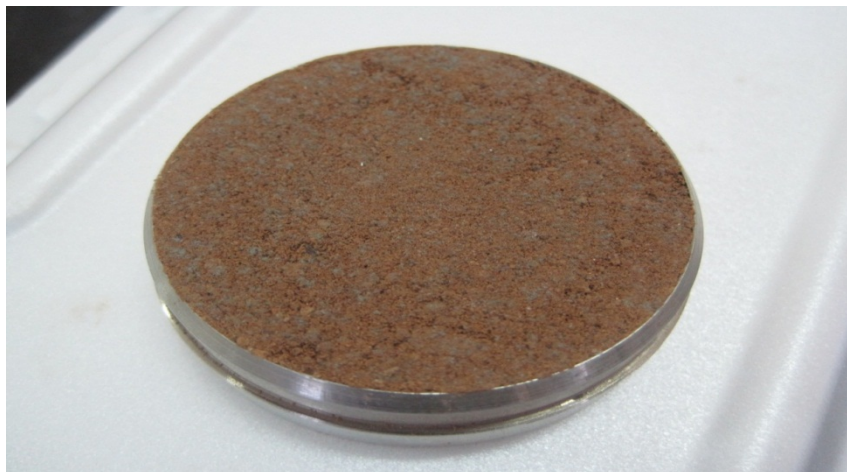
شکل ۷- نمونه پس از عمل آوری با باکتری باسیلوس اسفاریکوس
