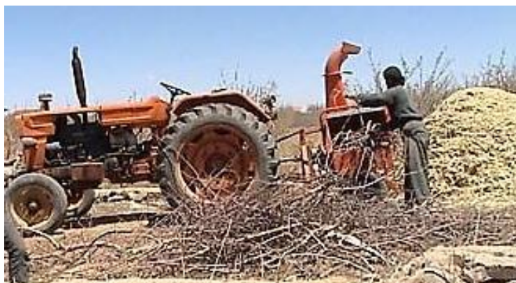
شکل ۲: دستگاه سرشاخه خردکن درختان باغی
