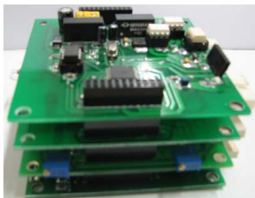
شکل ۱۵: شمای کلی از تمامی بردهای کنترل محلی
