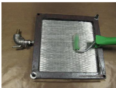
شکل (۳): نمایی از نحوه تولید کامپوزیت توسط آغشته‌سازی درجا
