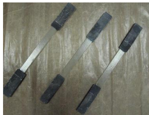
شکل (۴): نمایی از فک گیرها و نحوه قرار گیری آنها بر روی نمونه
