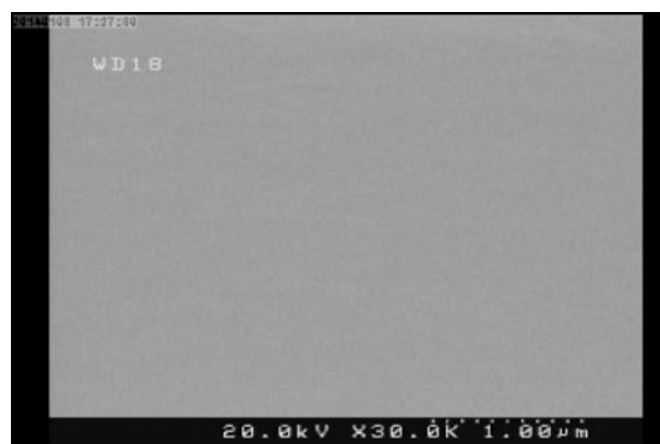
شکل ۶. تصویر SEM دوبعدی با دقت ۱µm از سطح سیلیکون‌های سونش شده در کف پنجره در TMAH با غلظت ۲۵٪ در دمای ۹۰°C در مدت ۹/۵ ساعت
