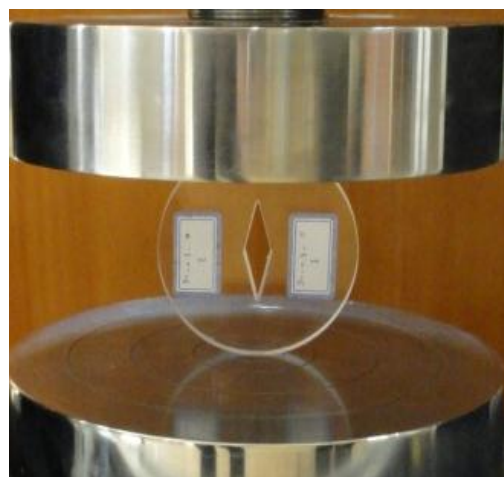
شکل ۱: نمونه دیسک برزیلی دارای شیاردار V شکل با سوراخ انتهایی حین انجام آزمایش شکست مد I خالص
