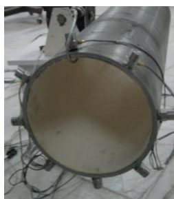
شکل ۸- چیدمان شتاب‌سنج‌ها و لرزش‌گر روی مدل در آزمایشگاه مودال
