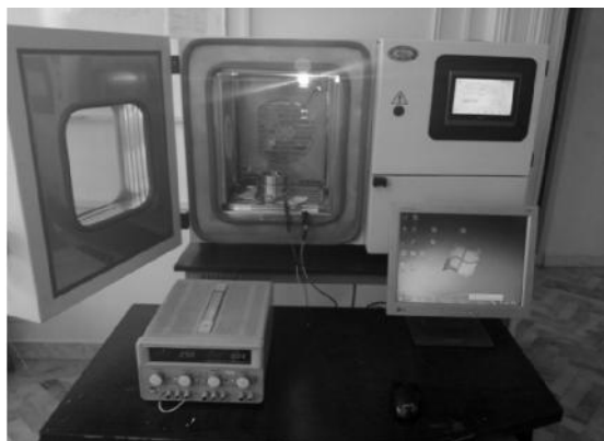
شکل ۸ - نمای محافظه حرارتی به همراه جاسازی چرخ عکس‌العملی در داخل محافظه
