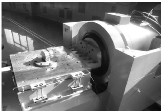
شکل ۶ - نمایی از نصب چرخ عکس‌العملی بر روی دستگاه شیکر
