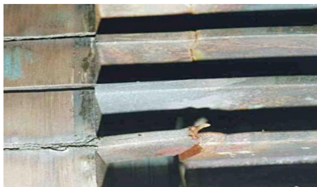
شکل ۱- شکست میله رتور موتور القایی
