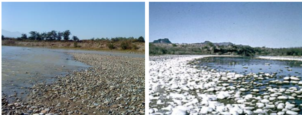
شکل 2- مقطع رودخانه مشابه برای برآورد ضریب زبری مانینگ در بازه میانی محدوده مطالعاتی، ضریب مانینگ برای بستر 0/031 و برای سواحل 0/043 (سمت راست راهنمای ضریب زبری، سمت چپ رودخانه مورد مطالعه)
