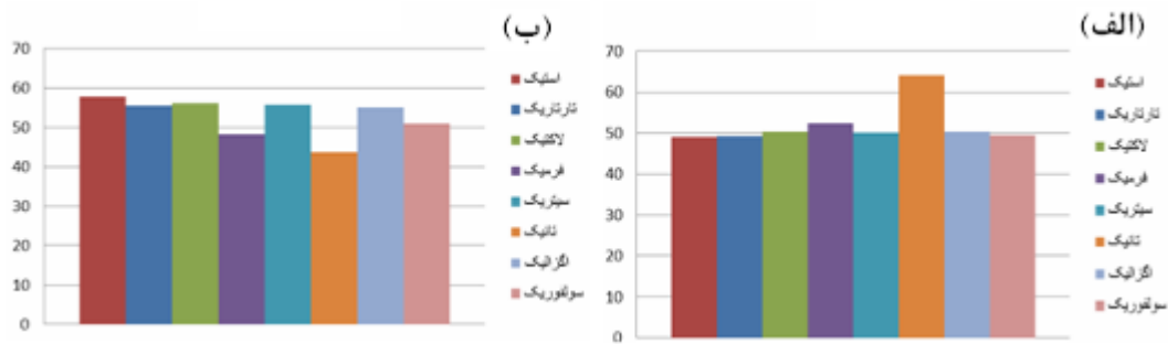
شکل ۸: مشخصه‌های رنگی نمونه‌های رنگ شده با اسیدهای مختلف در حضور زاج سفید الف) L* (ب) C*
