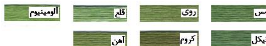
شکل ۴: نمونه‌های کالای رنگ شده با دندان‌های مختلف در حضور اسید سولفوریک
