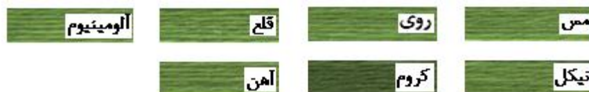
شکل ۴: نمونه‌های کالای رنگ شده با دندان‌های مختلف در حضور اسید سولفوریک
