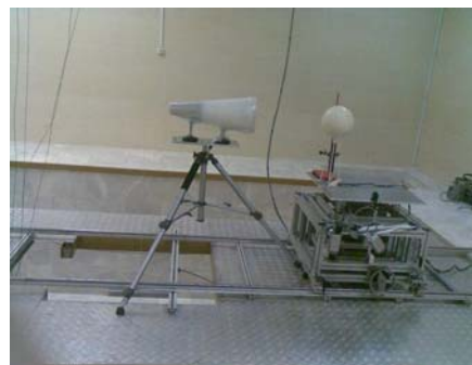
شکل ۲: نحوه ی چیدمان مخروط سایه و کره ی ۸ اینچ مقابل چشمه
