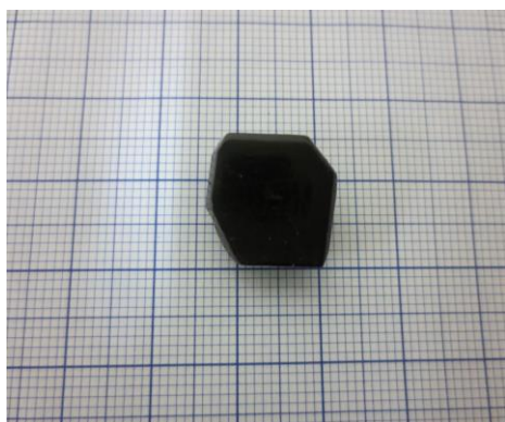
شکل 2- بلور سولفات نیکل کبالت با دوازده مولکول آب
