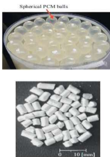
شکل ۱: مواد تغییر فاز دهنده به صورت میکروکپسول
