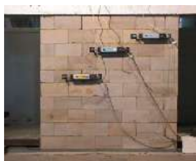
شکل (۴) ابعاد و هندسه ی نمونه ی آزمایشگاهی لورنزو (Lourenço et al., 2005)
