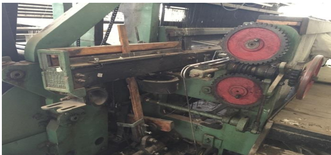
1- نمایی از دفتین و پرتاب ماکو دستگاه
