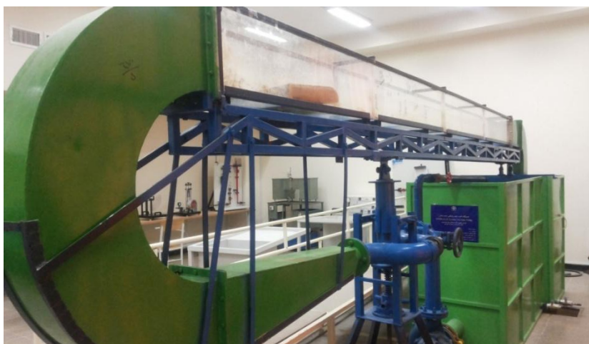
شکل ۱: فلوم مورد استفاده جهت بررسی تأثیر موانع بر پرس هیدرولیکی
