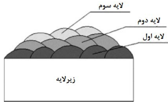
شکل ۱. شماتیک لایه‌های جوش داده شده [۵].
