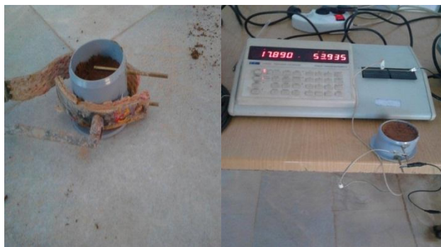
شکل ۱: نمودار دانه بندی برای نمونه های S1 و S2 و S3 شکل ۲: نحوه اندازه گیری مقادیر مقاومت نمونه ها
