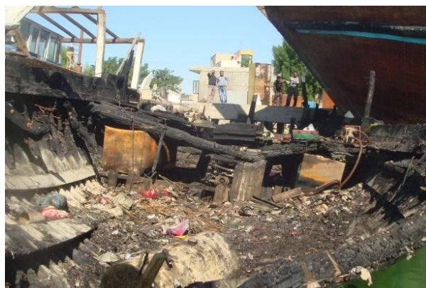
شکل ۱: آتش سوزی به دلیل اقدام به سوخت گیری پمپ روئین بنزینی در حالت روشن
