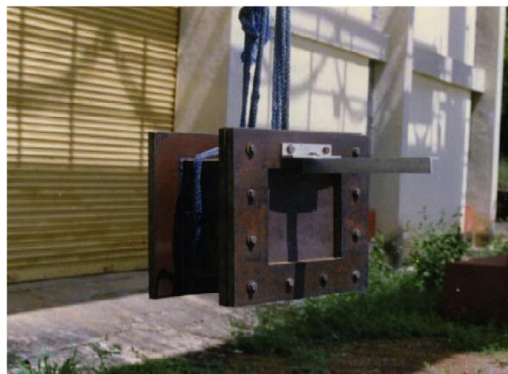
شکل ۳: شرایط مرزی ایجاد شده در ورق فلزی [۲]
