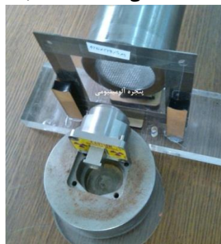
شکل ۴: نمایی از پنجره آلومینیومی آشکارساز
