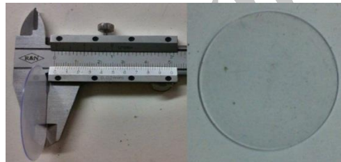
شکل ۳: ابعاد سوسوزن پلاستیک استفاده شده
