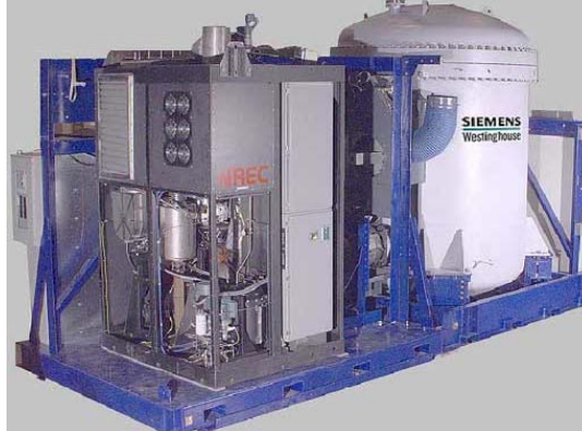
شکل ۳- اولین سیستم هیبریدی ساخته شده توسط شرکت زیمنس وستینگهاوس [۵]
