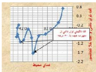
شکل ۲: روند افت توان ناشی از افت خلأ کندانسور ناشی از افزایش دمای محیط
