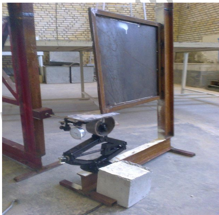
شکل (6): نحوه بارگذاری قاب دارایدیوار برشی فولادی
