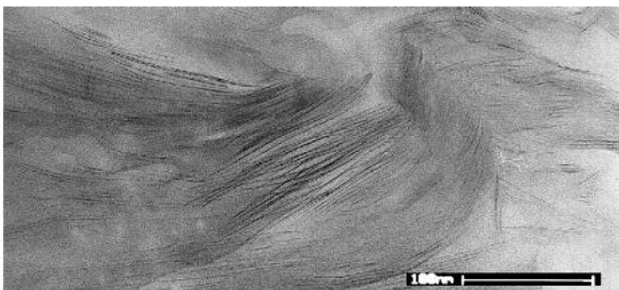
شکل 2: تصویر TEM نانوکامپوزیت اپوکسی نانوکامپوزیت Y-60 / اپون 10SC/828 3/
