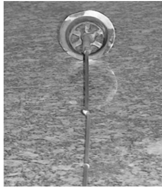
شکل ۲- همزن مورد استفاده برای انجام آزمایش های ته نشینی
