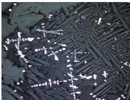
تصویر ۴. مگنتیت در بافت سیلیکاته فایالیت. بزرگنمایی \times 20
