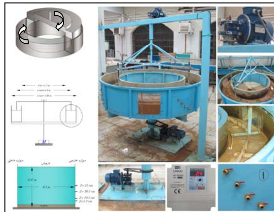
شکل ۲- نمایی از اجزای فلوم دایره‌ای مورد استفاده
