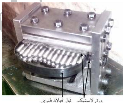
شکل (۴): قالب ساخته شده به همراه نوار فولاد فنی. ورق لاستیک نوار فولاد فنی
