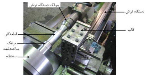
شکل (۷): نحوه قرارگیری قالب در دستگاه تراش.
