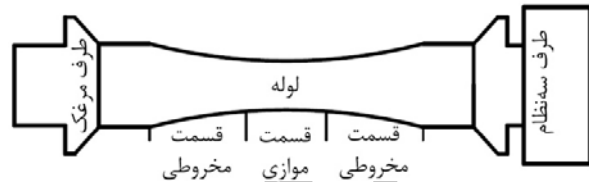
شکل (۱۸): تقسیم‌بندی منطقه تغییر شکل یافته در نمونه‌ها.
