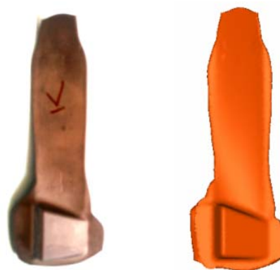
شکل (۲۰): مقایسه پره فورج شده؛ الف) المان محدود ب) تجربی.
