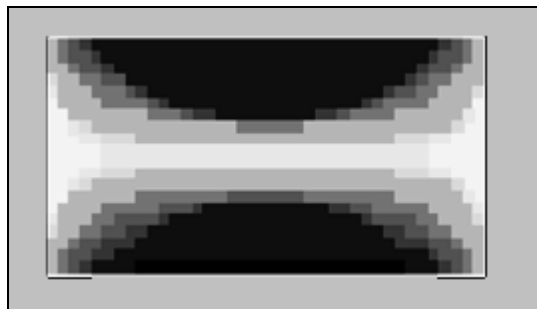
شکل ۱۰: کانتور تنش \tau_{xz} با ناپیوستگی حداکثر ۸۰ مگاپاسگال.
