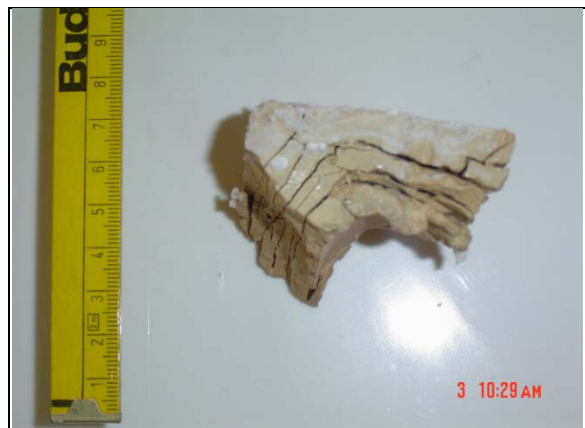
شکل ۲. تاثیر نمک سولفات سدیم بر روی آجر و خرد شدن نمونه
