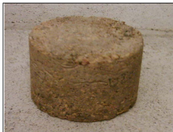
شکل ۱۰. نمونه‌های تثبیت شده با سیمان
