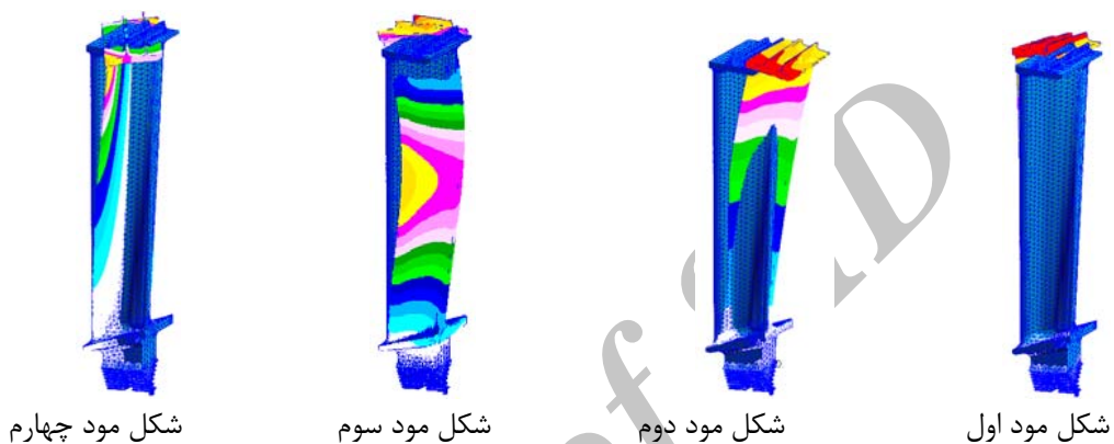
شکل ۱۰- ۴ مود اول به دست آمده پره چرخان با سرعت زاویه ای ۳۱۵ دور در دقیقه
