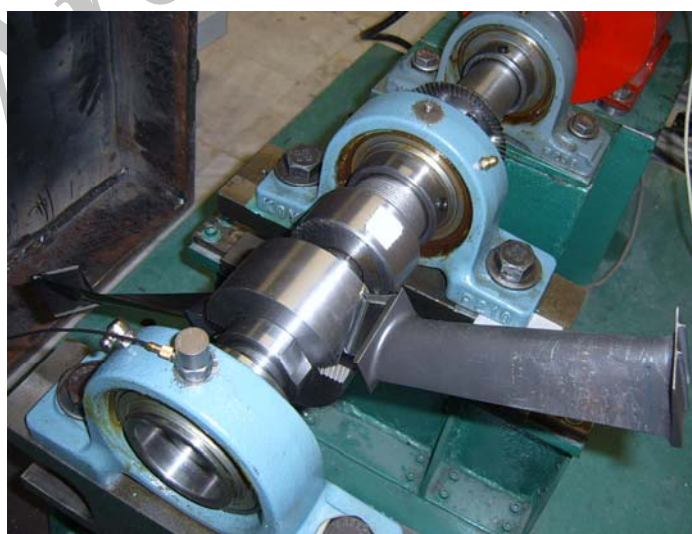
شکل ۲- نحوه تست آزمایشی پره در آزمایشگاه
