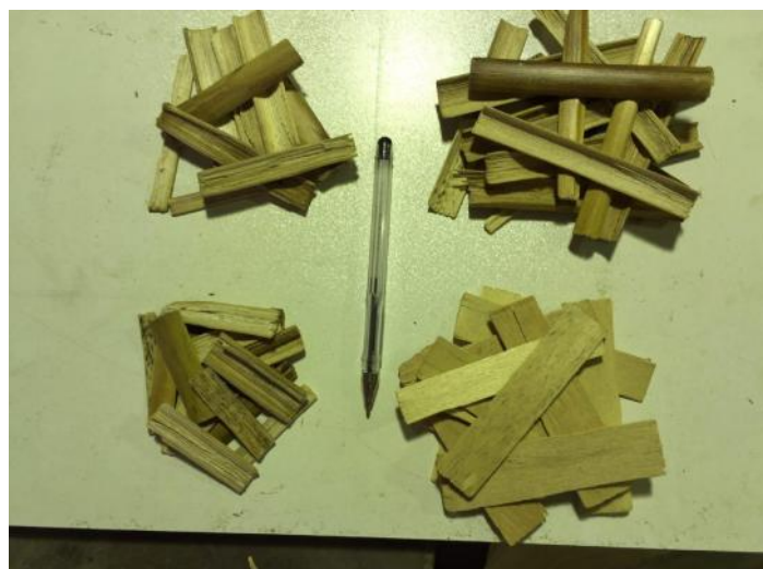
شکل ۱- تراشه‌های تهیه‌شده از ساقه ذرت در طول‌های مختلف و همچنین
