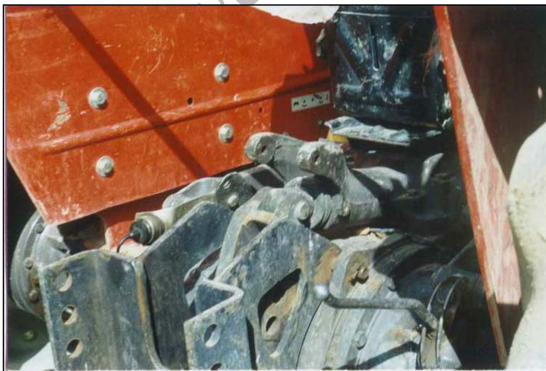
شکل ۶: محل نصب حسگر وضعیت اتصال سه نقطه
