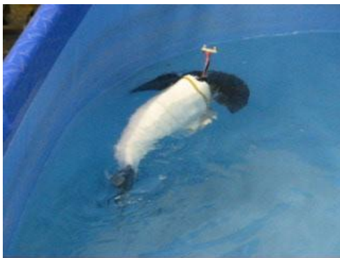
شکل ۲۲: اعمال کنترلر روی میکرو زبرداریی و پایداری حرکت آن در یک باند ۲۰ سانتی متری و با فاصله ۱۰ سانتی از دیواره.
