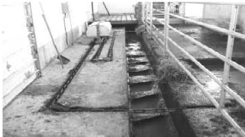
شکل ۲- کانال، موتور الکتریکی، پره‌های کف کانال و زنجیره‌های رابط در حین کار (بدگرفارم، ۲۰۰۷).
