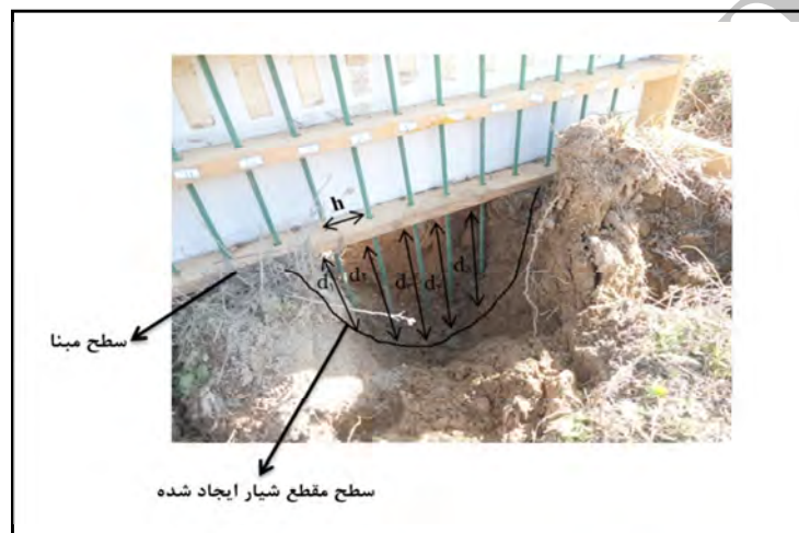
شکل ۲- اندازه‌گیری سطح مقطع شیار ایجاد شده به کمک پروفیل متر ( h برابر است با ۳ سانتی متر)
