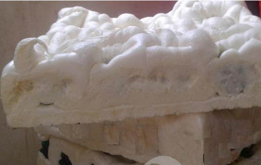
شکل ۲- پوشش یورتالات قبل از پاشش بتن (تصویر سمت راست)، پوشش یورتالات بعد از پاشش بتن (تصویر سمت چپ)
