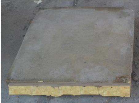
شکل ۲- پوشش یورتالات قبل از پاشش بتن (تصویر سمت راست)، پوشش یورتالات بعد از پاشش بتن (تصویر سمت چپ)
