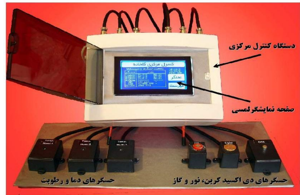
شکل ۱. نمای کلی و اجزای دستگاه کنترل مرکزی شرایط محیطی گلخانه‌ای
