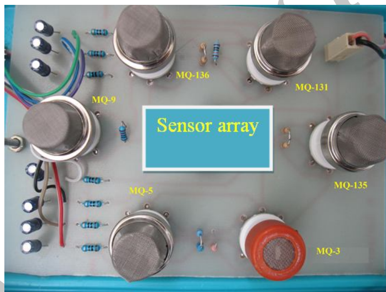
شکل ۳- مداربندی آرایه حسگری سامانه طراحی شده
