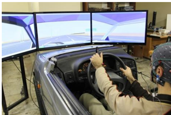
شکل ۱- تصویر شبیه ساز رانندگی به کار رفته برای ردیابی خستگی ذهنی راننده.
